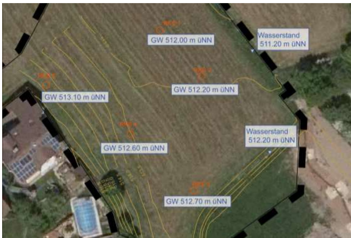
Erkundete (Grund-) Wasserstände bei durchgeführten Kleinrammbohrungen (Geotechnikum 2021)
